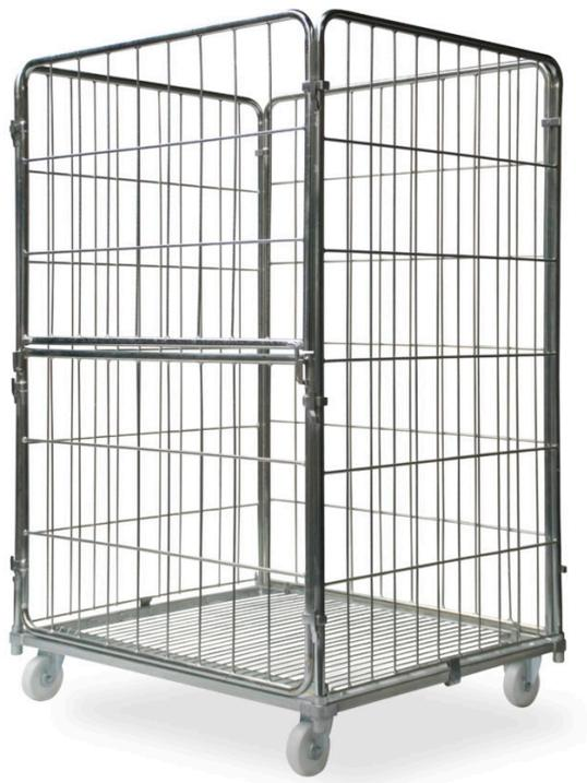
Roll Blanchisserie à louer 1200x1000x1800 mm et dimensions intérieures 1140x940x1640 mm. Conteneur à linge grande contenance en acier galvanisé possède une 1/2 ouverture rabattable avant, une capacité de charge de 400 kg, et 2 roues pivotantes
