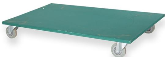
Plateau de manutention roulant XL avec 4 roues pivotantes en caoutchouc diamètre 100 mm. Capacité de charge 500 kg
