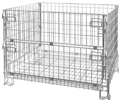
Conteneur métallique grillagé pliable 1200x1000x1000mm à louer, de dimensions intérieures 1126x969x872mm et d'une capacité de charge maximale 500 kg. Ce conteneur est empilable, gerbable et possède 1/2 porte rabattable en façade
